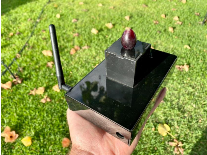
Figura 4 - Protótipo do equipamento: avalia os atributos e ponto de maturação da uva na palma da mão
