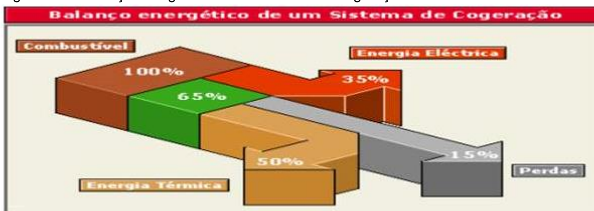
Figura 19 – Balanço Energético de um Sistema de Cogeração
