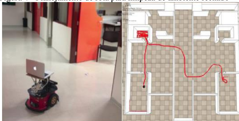
Figura 4 - Planejamento de rota para limpeza de ambiente fechado
