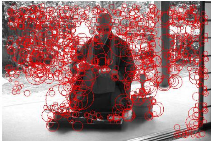
Figura 41 - Exemplo de aplicação do OpenCV utilizando o SURF
