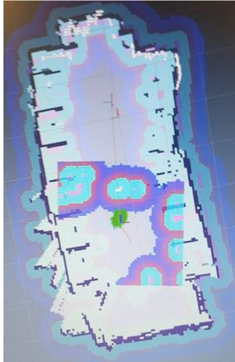
Figura 37 - Mapa do laboratório de pesquisa construído pela plataforma robótica
