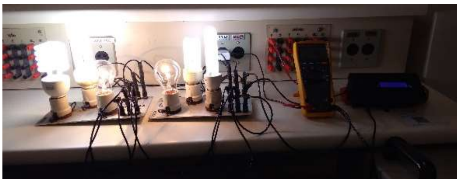
Figura 33 - Teste de bancada - Lâmpadas Fluorescentes e Incandescentes
