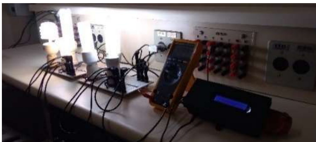
Figura 32 - Teste de bancada - Lâmpadas Fluorescentes
