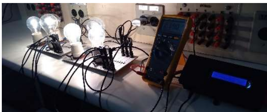
Figura 31 - Teste de bancada - Lâmpadas Incandescentes
