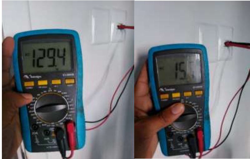
Figura 36 - Valor de tensão /Fase - Neutro e Neutro –Terra
