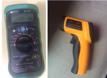
Figura 5 - Aparelho medidor multifunção IP-233 (Impac) e termômetro infravermelho Ufree GM300 (CE)
