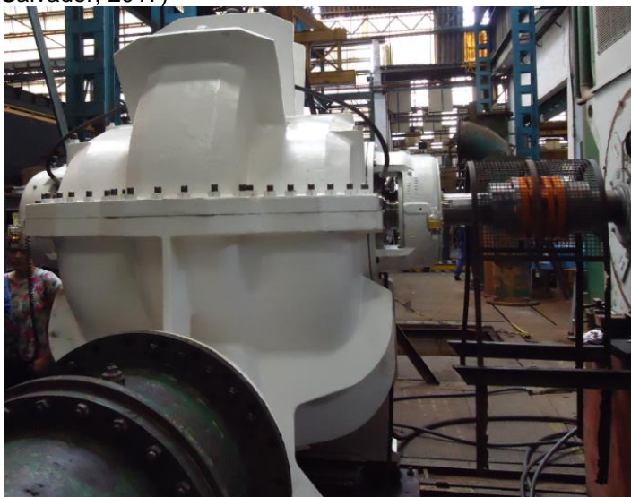
Figura 4.14 – Bomba horizontal de água de circulação da torre de resfriamento (Salvador, 2017)
