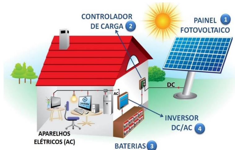
Figura 9 - Sistema fotovoltaico isolado
