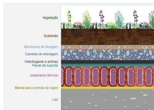
Figura 20 - Camadas de uma cobertura verde
