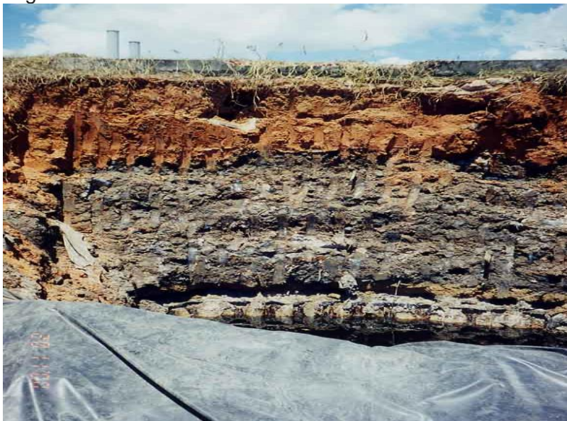
Figura 19 - Primeiro corte feito no landfill
