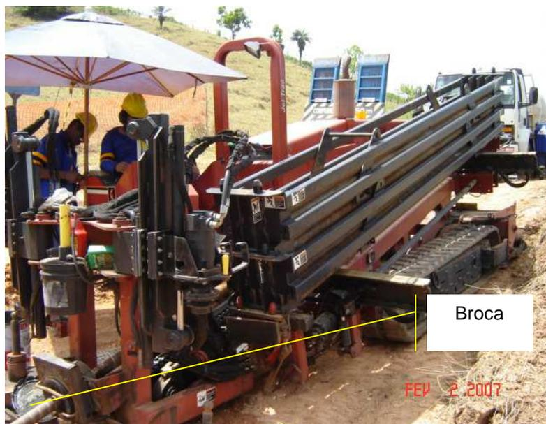
Figura 10 - Máquina usada para efetuar o furo direcional
