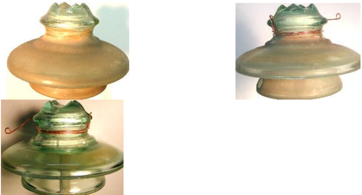
Figura 25 - Isolador de vidro. a) como retirado da RD; b) após uma primeira lavagem; e, c) após segunda lavagem com procedimento manual para a retirada das sujidades depositadas Fonte: Portela (2008).
