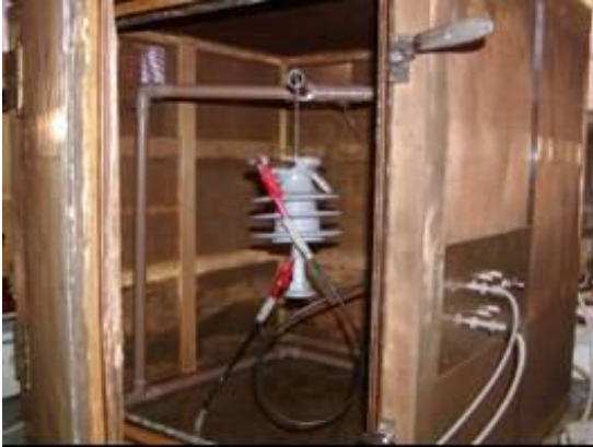
Figura 14 - Arranjo experimental utilizado para as medidas de resistência de isolamento em isoladores. Foto ilustrando a montagem dos eletrodos entre a cabeça do isolador e o pino de sustentação
