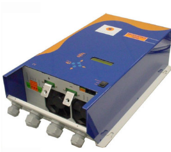
Figura 59: Inversor 3 kW. A foto mostra os contatos para conexão com o banco de baterias e Painele de ligação com as cargas, chave liga – desliga e indicadores de estado do banco de baterias.
