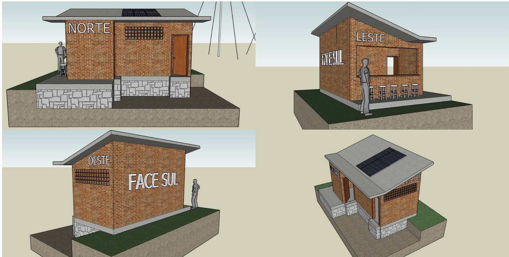
Figura 74: Projeto da casa de potência e controle. Fonte: Elaboração própria utilizando o SketchUp .
