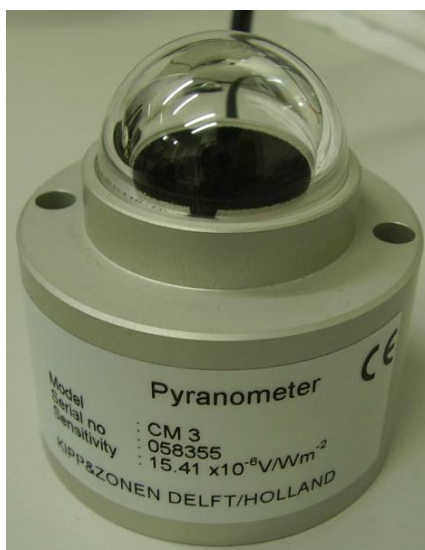
Figura 39: Piranômetro fotovoltaico testado em laboratório. Fonte: Elaboração própria.
