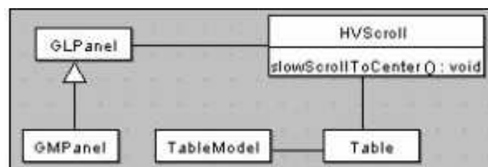
Figura 5.21. Diagrama das classes do controle de detalhes sob demanda.
