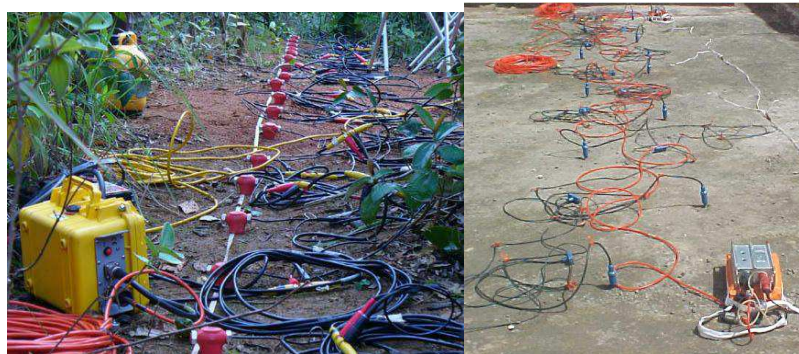
Figura 3.2 - Sistema cabeado para transmissão de dados sísmicos. Sismógrafos e Geofones em operação de campo, à direita Alphageofísica (2010) e á esquerda
