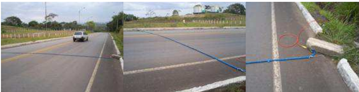
Figura 3.3 - Cabeamento dos geofones nas estradas
