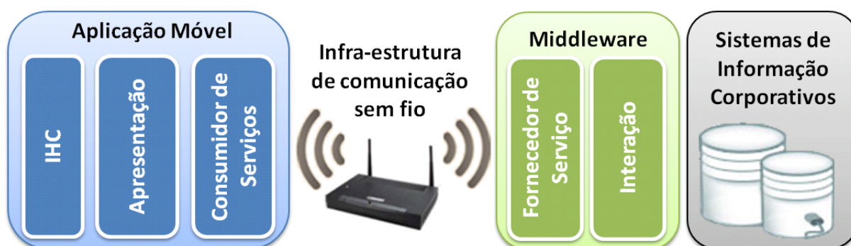
Figura 3.4 - Camadas da arquitetura para construção de aplicações móveis Nota: Elaboração do autor (2009).
