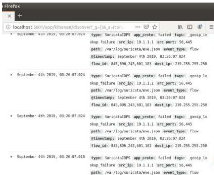
Figura 50 – Logs de alertas detalhados gerados pelo Kibana baseados na leitura de arquivos json do Suricata IDS
