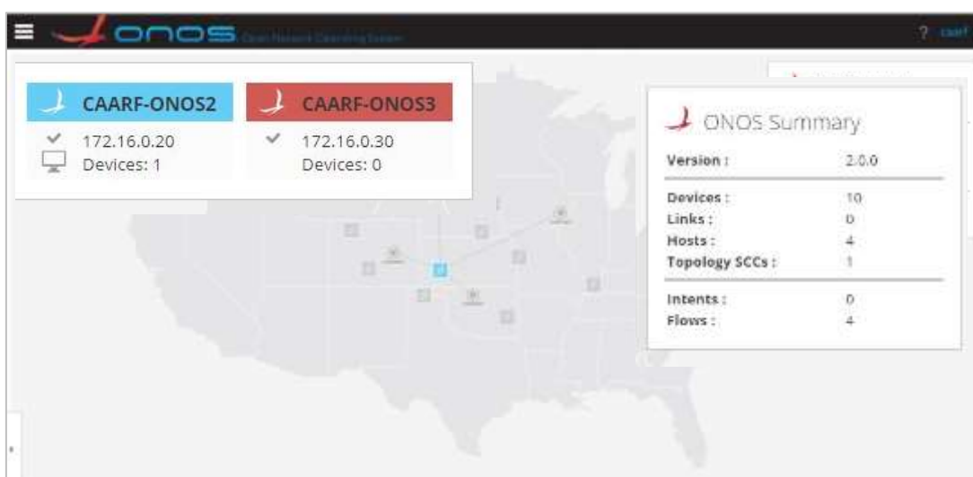
Figura 56 – Estado do cluster de controladores após falha em uma das instâncias
