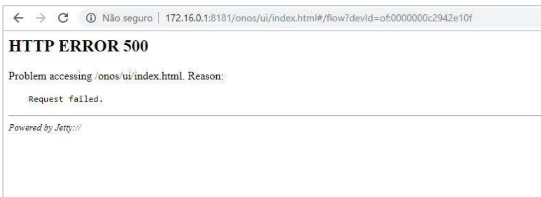
Figura 30 – Falha total na GUI Web do controlador ONOS
