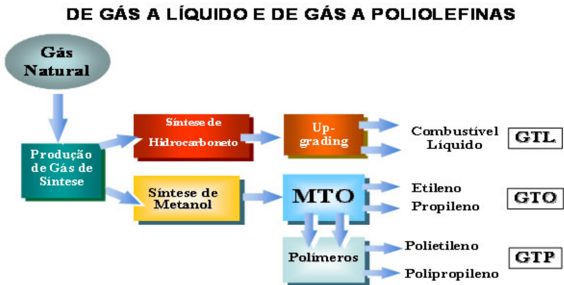
Figura 29 – Esquema simplificado da transformação de gás natural para combustível líquido e produtos petroquímicos Fonte: CANTALINO, 2003.
