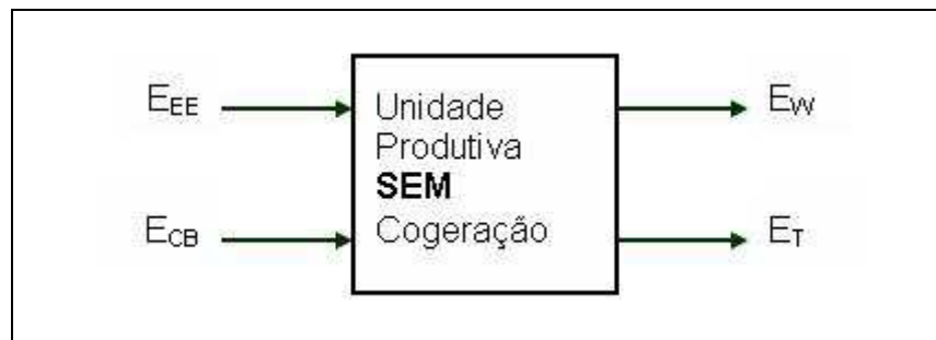
Gráfico 5.18 - Esquema de necessidade Energética da UC segundo os modelos propostos SEM Cogeração
