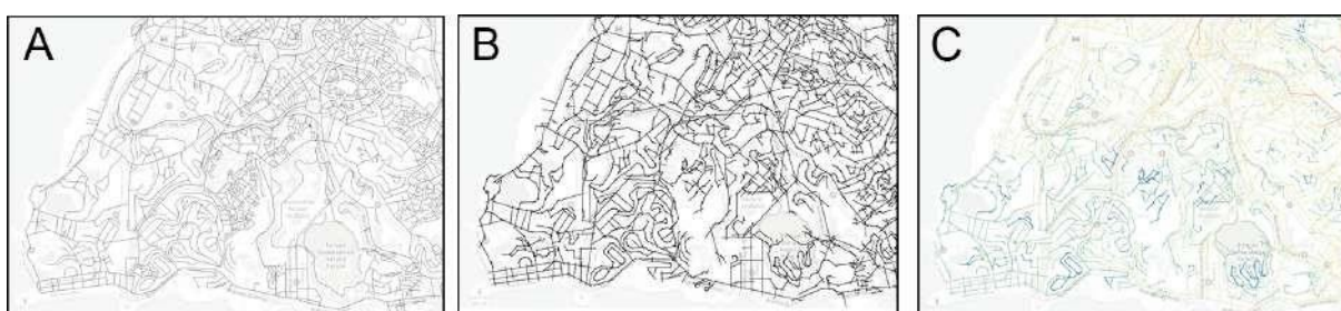
Figura 2 – Processo de construção do Mapa Axial em trecho da cidade de Salvador. (A) corresponde ao traçado de uma linha reta sobre cada via. (B) A fração da malha obtida é traduzida em um mapa axial quantificado, permitindo a construção de uma matriz de conexões. (C) A matriz permite a construção de mapas colorizados que indicam os valores de integração, com raio global (Rn)
