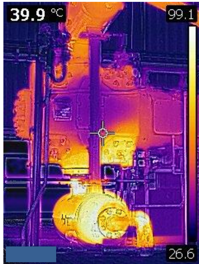
Figura 26 - Aumento de temperatura no cilindro do GB-104
