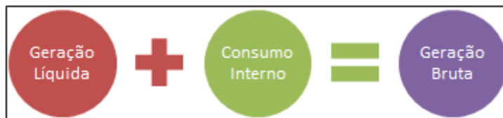
Figura 6.2 – Balanço Energético simplificado da UTE estudo de caso
