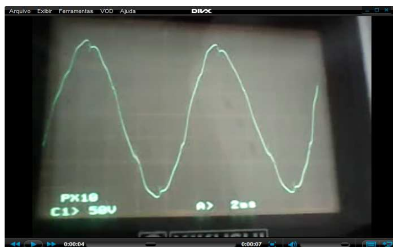
Figura 25 - Forma de onda da tensão da rede da concessionária com carga
