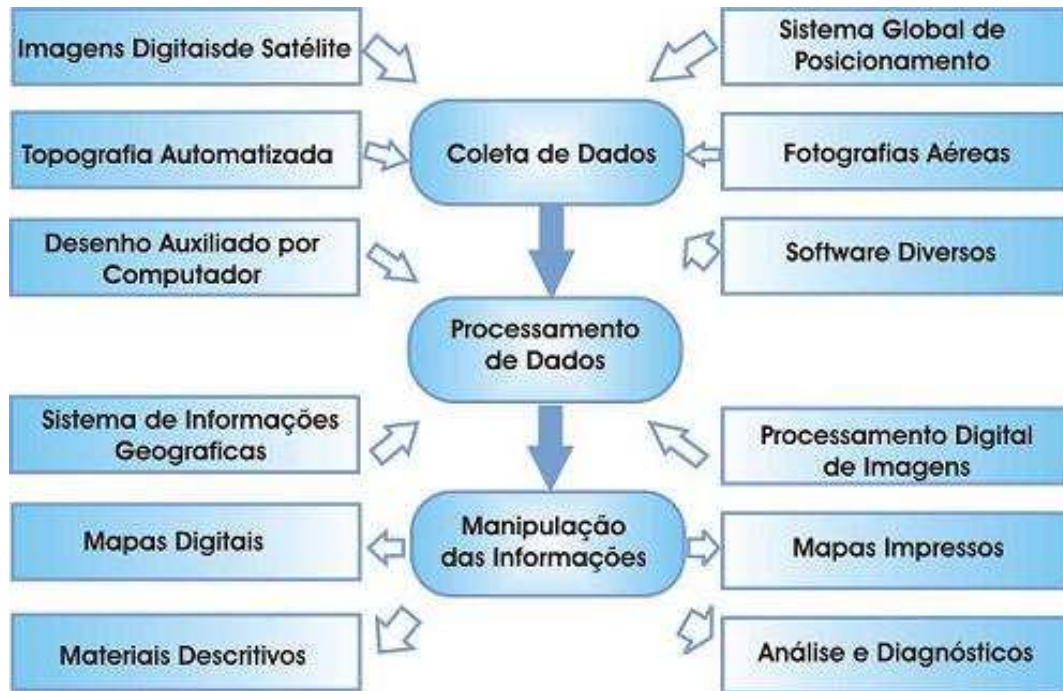
Figura 5 – Processo de coleta, processamento de dados e manipulação das informações
