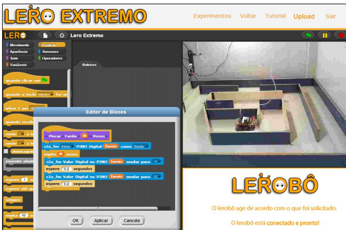
Figura 5.9 – Tela com o script para funcionamento do novo bloco no LERO Extremo
