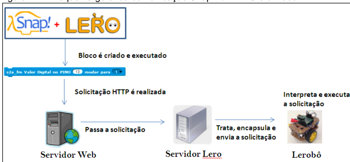
Figura 4.7 – Esquema geral da comunicação Snap! for LERO e o Robô
