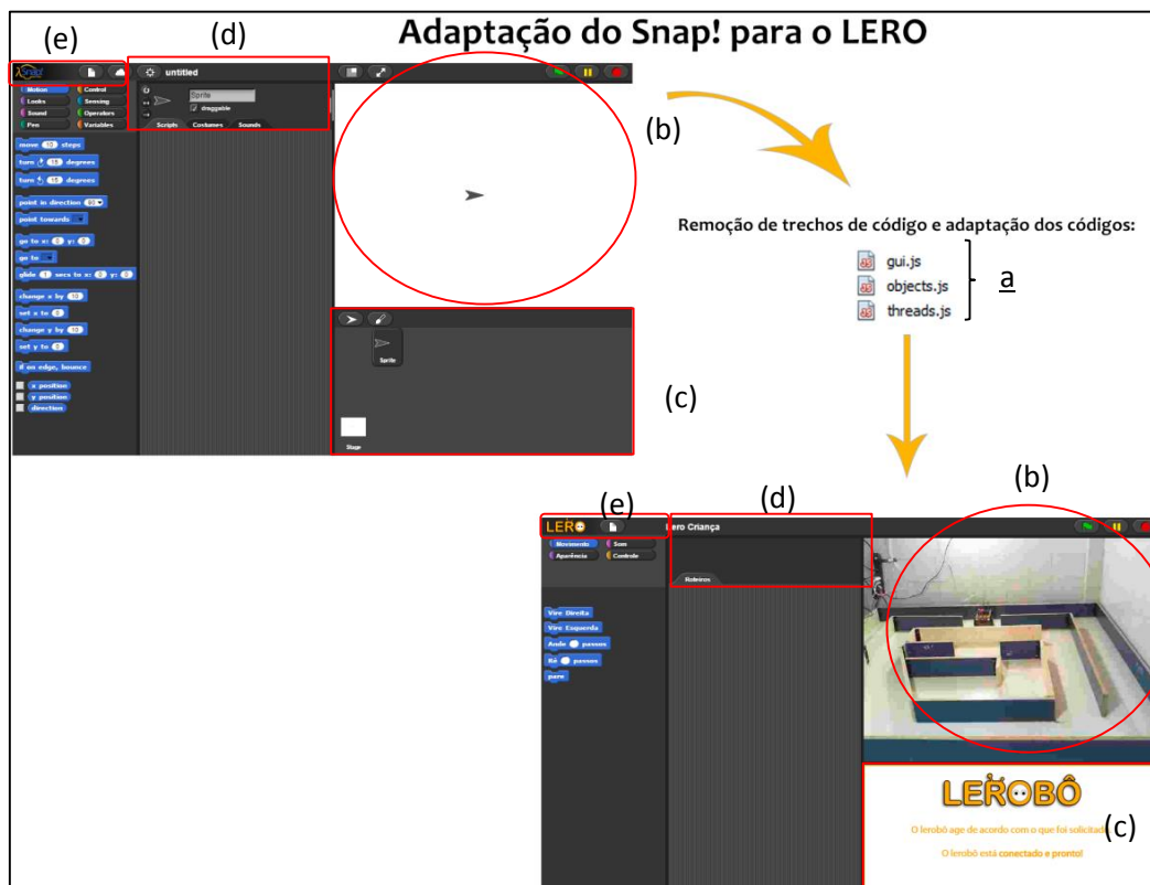
Figura 4.5 – Adaptações do Snap! para o Snap! for LERO
