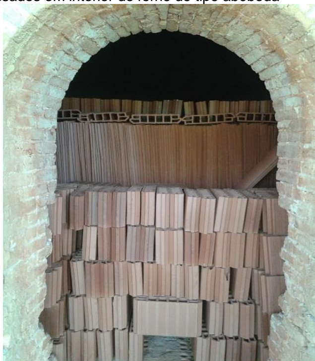
Figura 15 – Blocos assados em interior de forno do tipo abóboda
