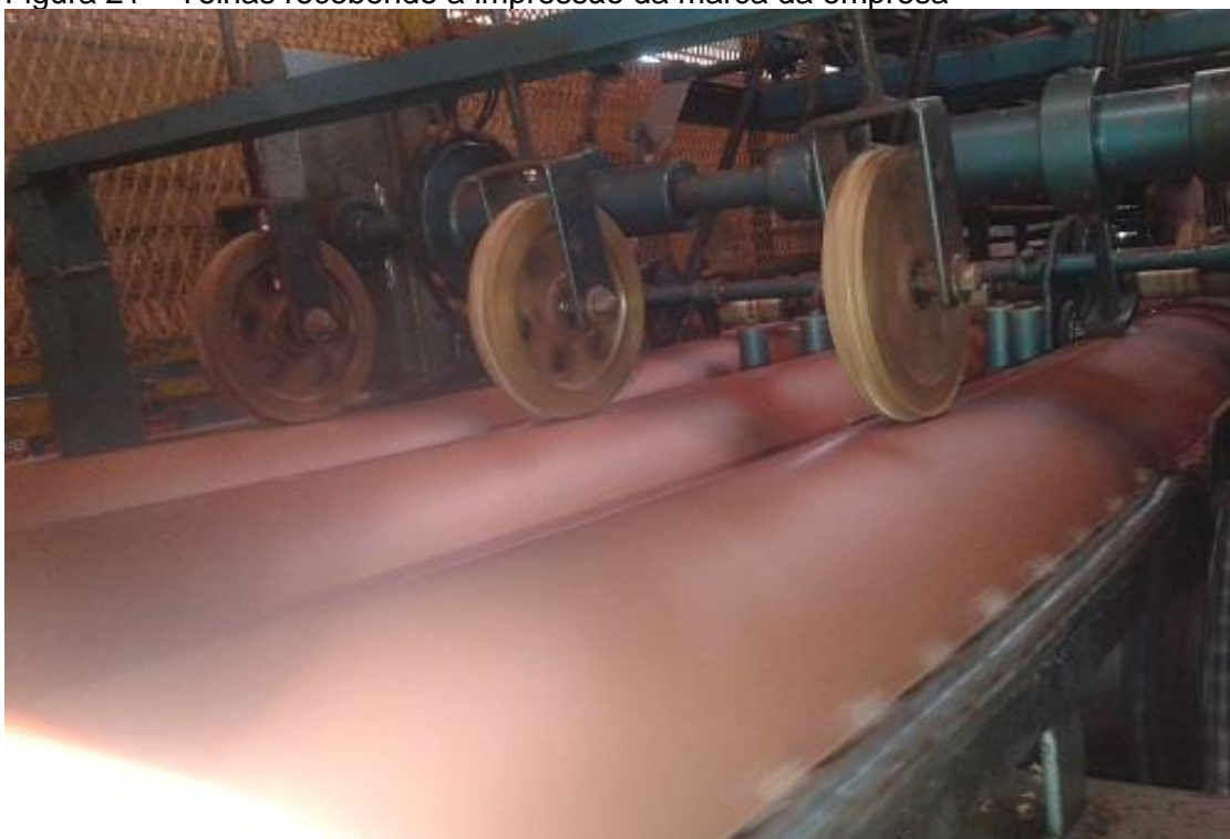
Figura 21 – Telhas recebendo a impressão da marca da empresa
