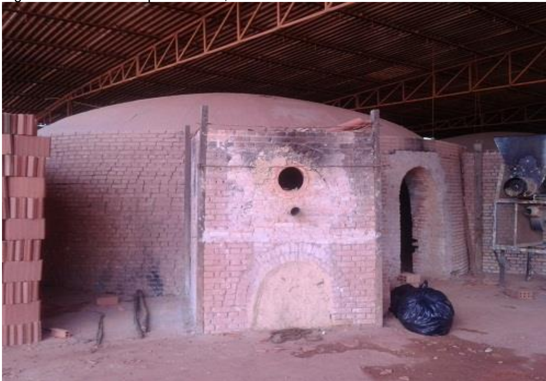
Figura 14 – Forno do tipo abóboda, utilizado na maioria das indústrias cerâmicas
