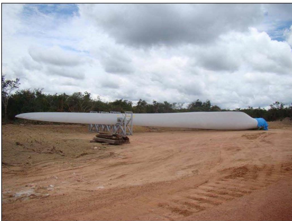
Pá do aerogerador desmontada Complexo Eólico da Desenvix – Brotas de Macaúbas - BA Fonte: Fabiano Staut, 15/02/2011.
