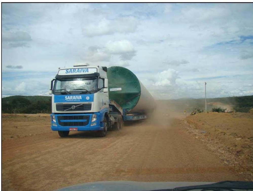
Transporte de uma peça da torre no acesso ao Complexo Eólico da Desenvix – Brotas de Macaúbas - BA Fonte: Fabiano Staut, 15/02/2011.
