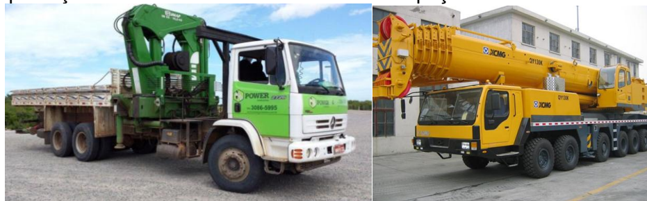
Figura 19 – Guindastes [a) veicular; b) hidráulico sobre caminhão] utilizados para içamento e deslocamento horizontal de peças metálicas veicular
