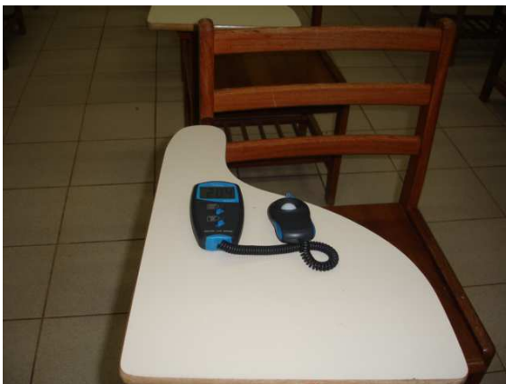
Figura 13 – Medição da iluminância no campo de trabalho Nota: Realizado pelo mestrando
