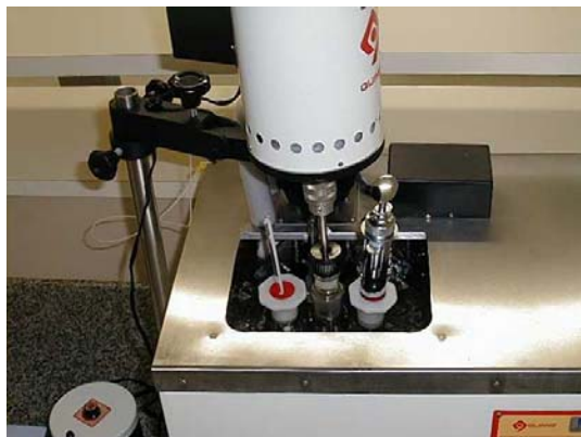
Figura 9 - Etapa de aquecimento e agitação do óleo usado
