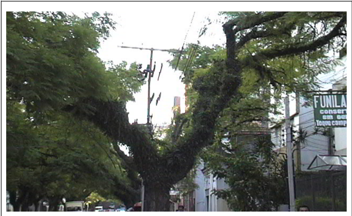
Figura 5: Impacto das podas em árvores causado pela rede primária. Fonte www.inbrac.com.br .
