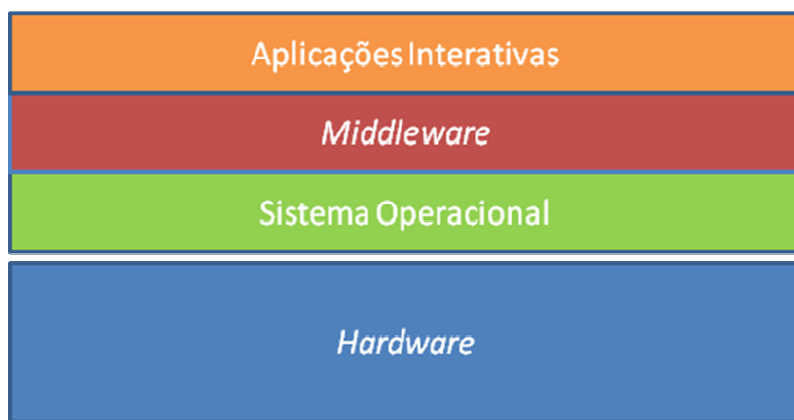
Figura 5 - Arquitetura de camadas de um sistema computacional de TVD
