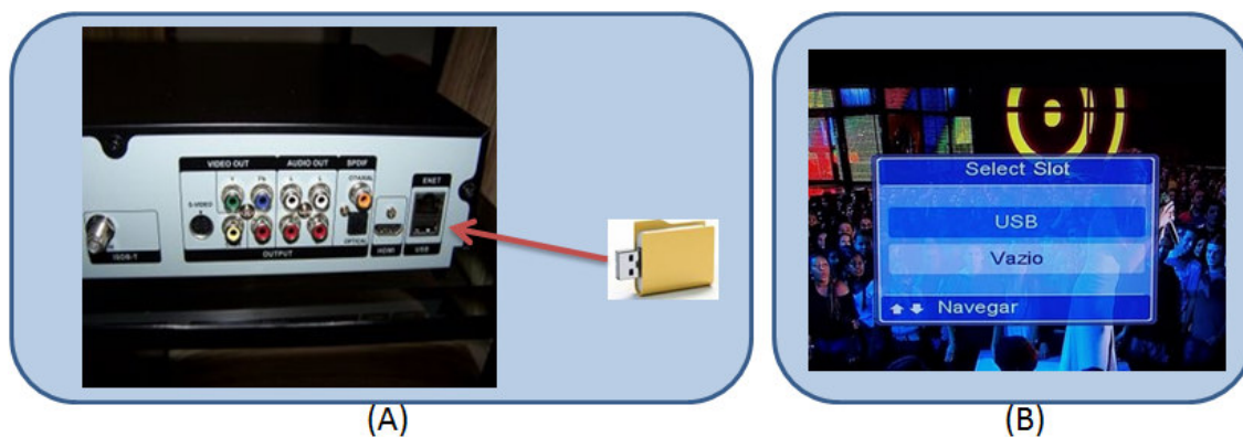
Figura 11 - (A) Visão posterior do SBT Zinwell ZBT-620A. No detalhe, conector USB. (B) Seleção do dispositivo USB para acesso a dados no armazenamento externo
