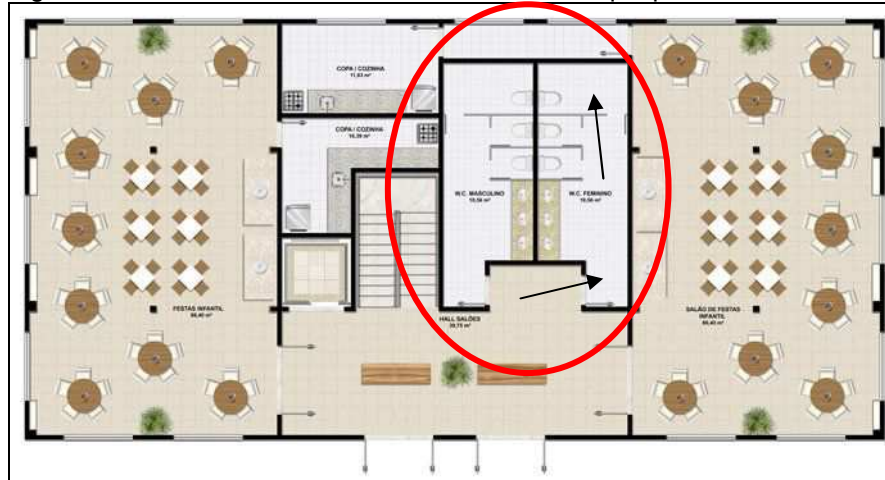
Figura 17 - Condomínio Cores de Piatã com destaque para o sanitário acessível
