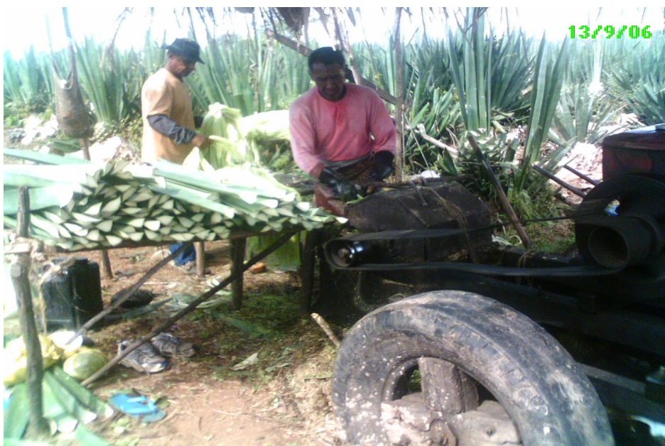
Figura 14: O desfibramento da fibra utilizando a máquina Paraibana (campos de sisal de Valente) Fonte: Foto da autora (2006)
