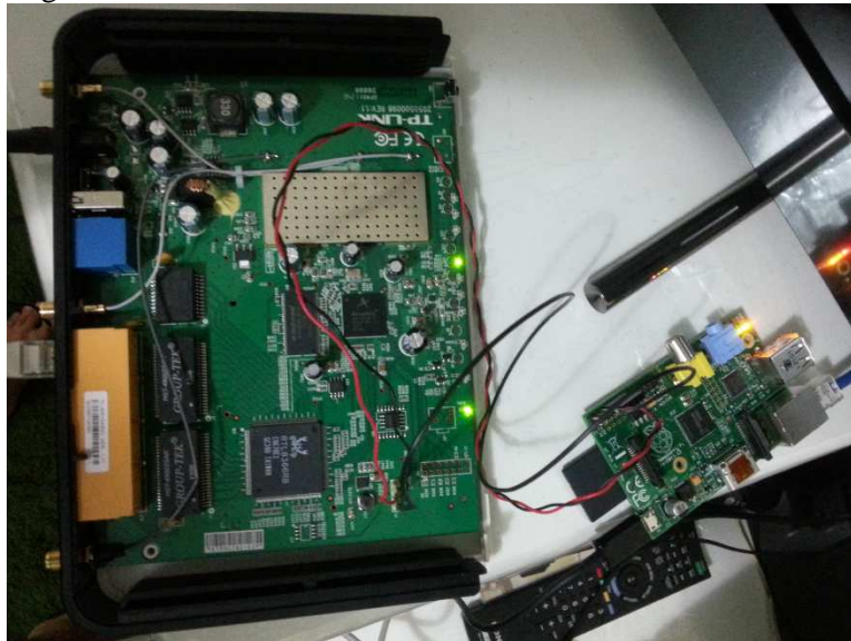
Figura 45 - Realizando “unbrick” no encaminhador
