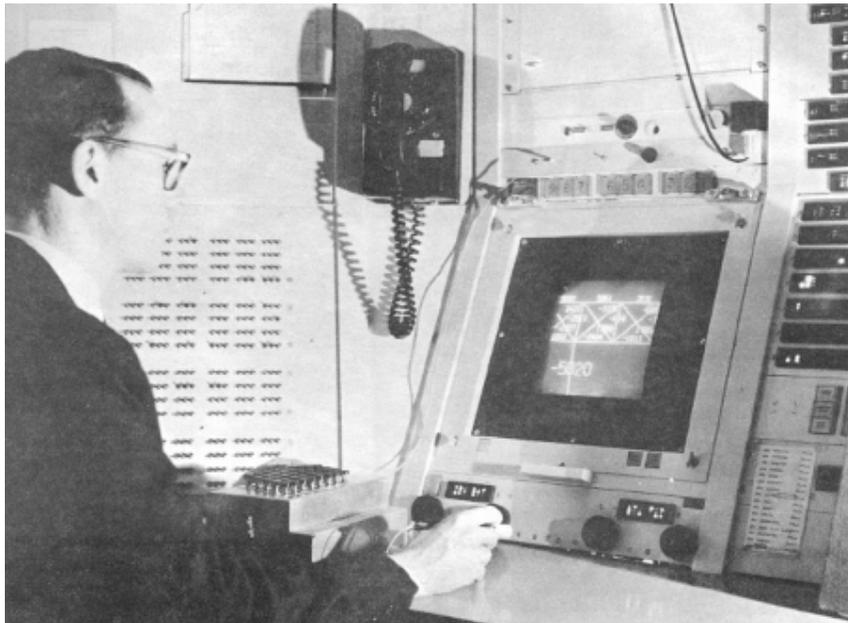
Figura 6 – O Sketchpad, com parte de uma ponte em destaque na tela.
