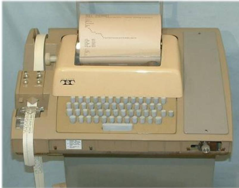
Figura 4 – O teletipo IBM ASR-33
