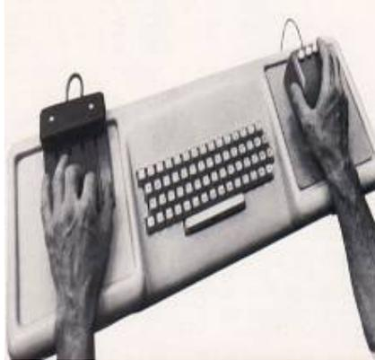
Figura 8 – Dispositivos de Entrada do NLS: mouse, teclado e keyset
