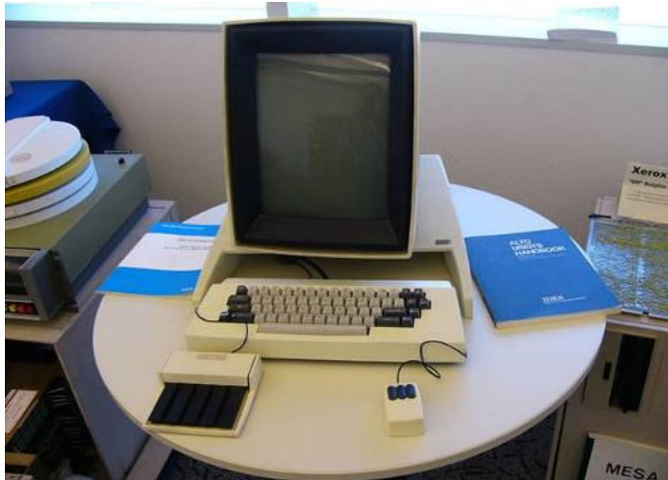
Figura 9 – O Xerox Alto: monitor, teclado, *mouse* e *keyset*
